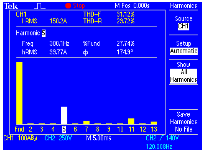
Durchführen von Oberwellenverzerrungsmessungen mit der Software TPS2PWR1
